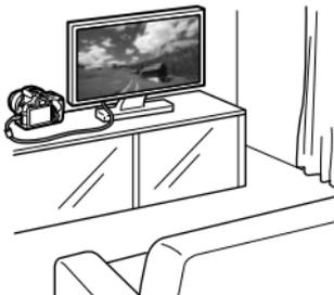
Utilize o cabo AV estéreo AVC-DC400ST (vendido em separado) ou o cabo HDMI HTC-100 (vendido em separado) para ligar a câmara a um televisor. Em seguida, pode reproduzir os filmes e as fotografias captados no televisor. Se tiver um Televisor de Alta Definição e ligar a câmara ao mesmo utilizando um cabo HDMI, pode ver filmes em Alta Definição Total (Full HD: 1920 x 1080) e Alta Definição (HD: 1280 x 720) com uma imagem de qualidade superior.
